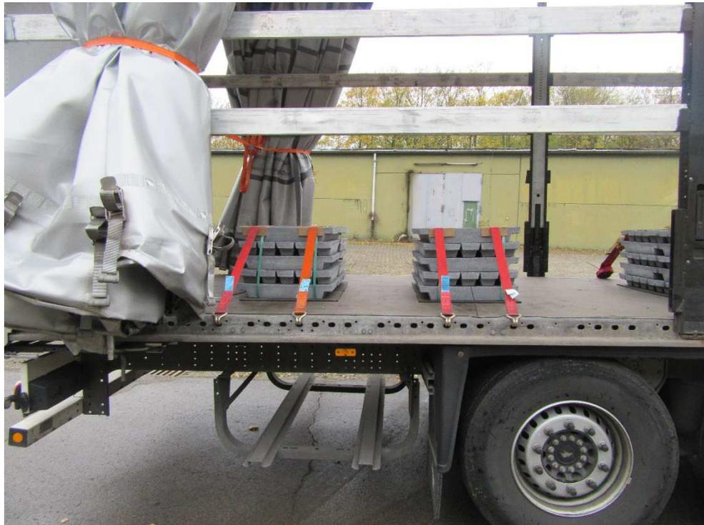
Posizionamento delle cinghie di fissaggio in ogni fila di carico
