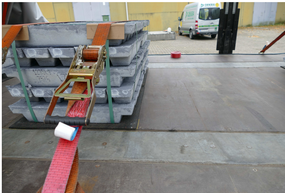
Antislipmatten dienen de volledige oppervlakte van elk pakket te bestrijken
