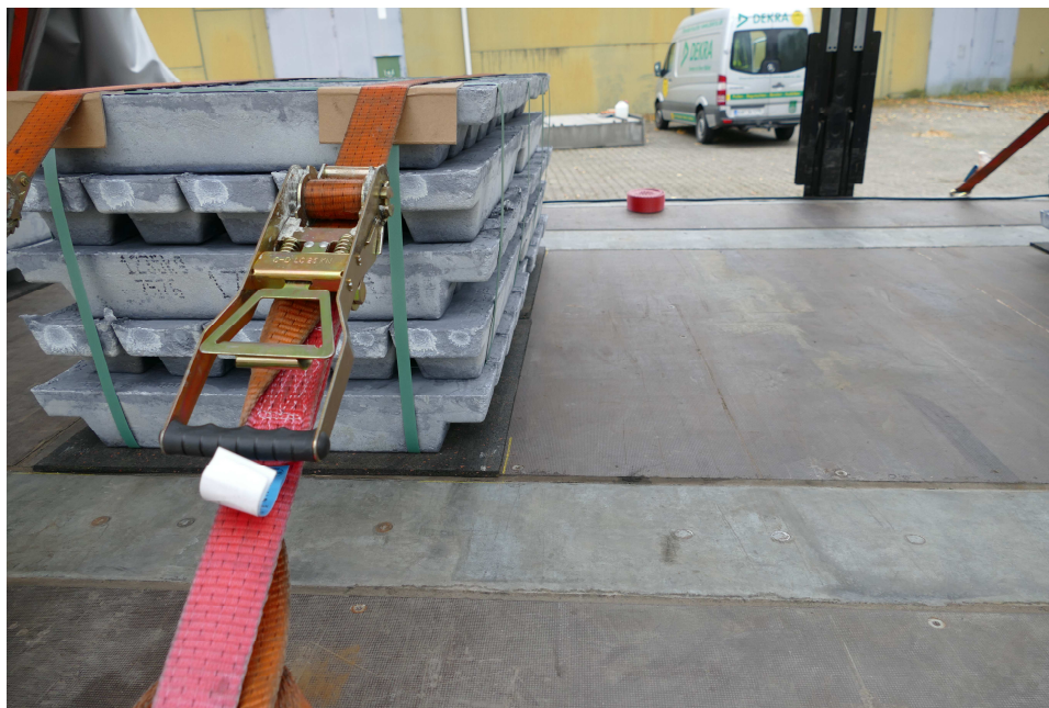
Protišmykové podložky položené pod každé balenie po celej ploche
