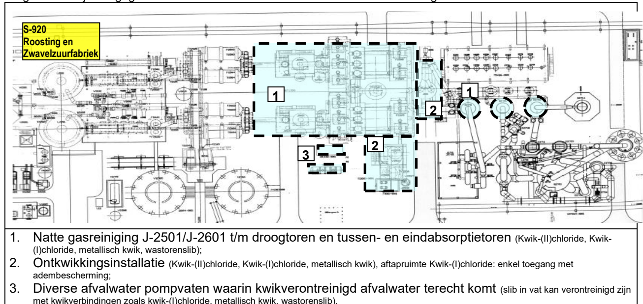
Figuur 2: Plattegrond gebieden met kans op blootstelling aan kwikdamp De gebieden zijn aangegeven omdat er in het verleden ooit metallisch kwik is aangetroffen in de installatie.
