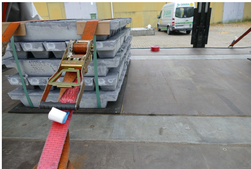
Csúszásgátló szőnyegek teljes felületen elhelyezve minden csomag alatt
